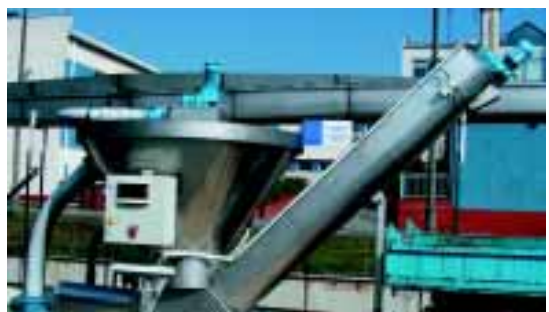
Zintegrowany separator z płuczką piasku
