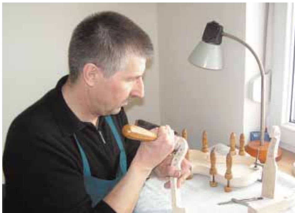
Rzeźbienie dłutem „główki ślimaka”. Zadanie to pochłania wiele czasu. Po wykonaniu tego elementu poznaje się klasę lutnika.
