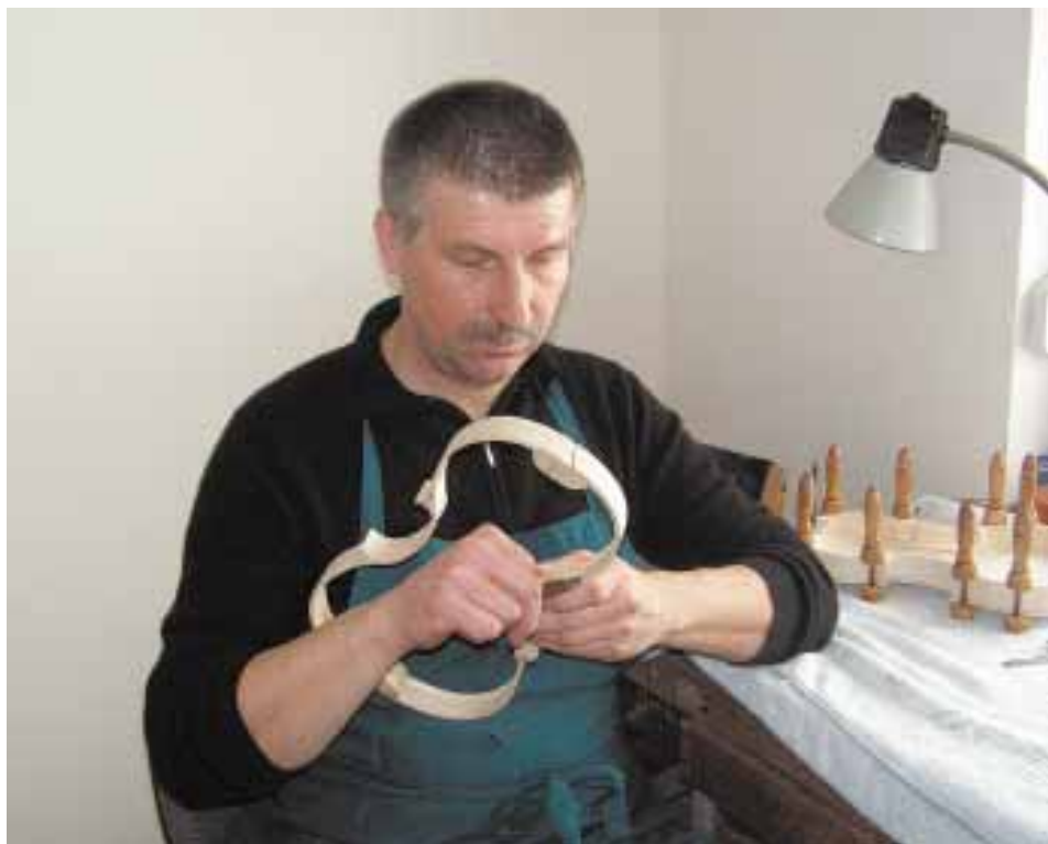
W swojej pracowni lutnik prezentuje boczki do skrzypiec, składających się z 24 elementów, które „nabija się” na specjalnej formie.
